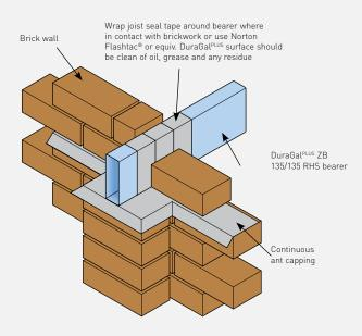
DURAGAL<sup>ULTRA</sup> ANGLE TO BRICKWORK SEALING
